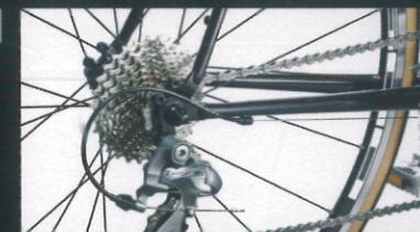
鍛造ストレートドロップエンド アイレット付
