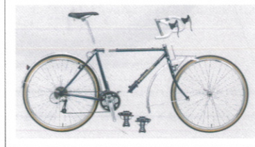
両側の変速レバーを前方に倒しワイヤーの接合部を外す。 ペダル、サドルを取り外し、各フレームの接合部を矢印の 方向にひねりながら外し、各パイプ先端にキャップをはめます。
