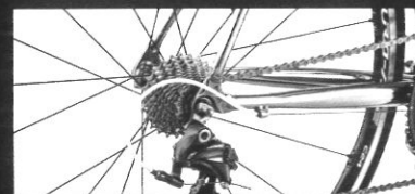
強靱なロストワックス6AL4V Ti合金ストレートドロップエンド
